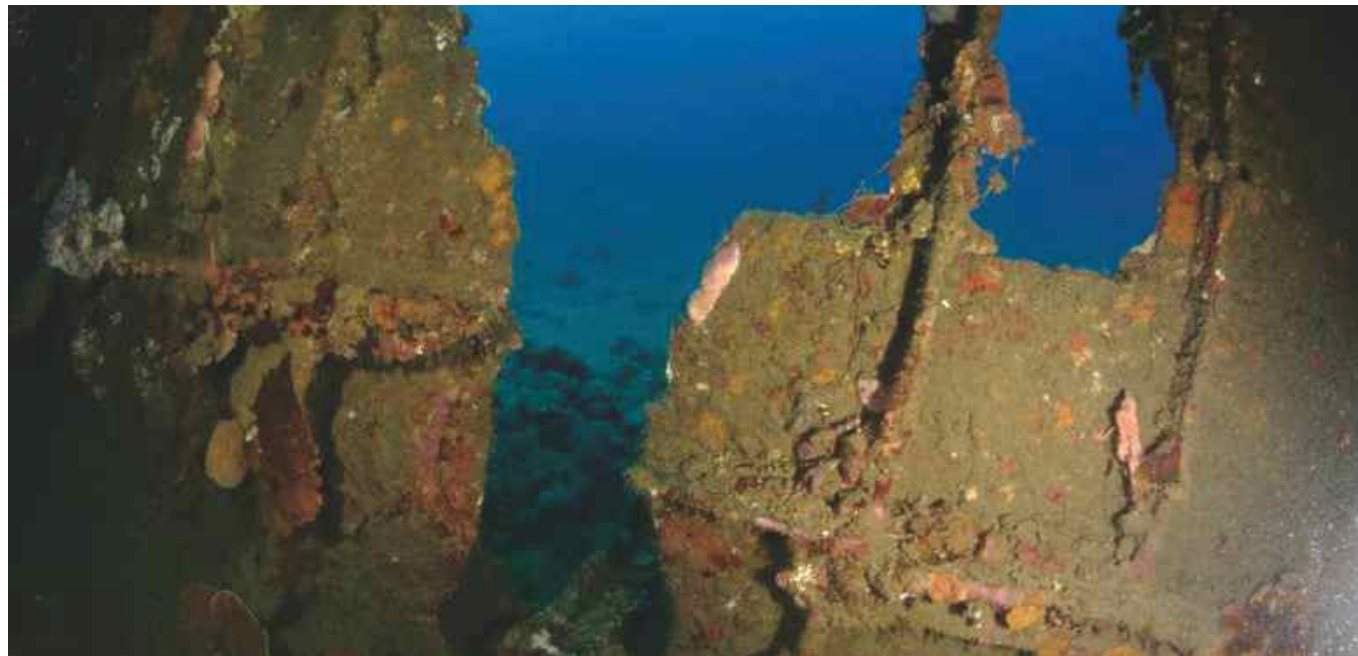
Lubang dan rekahan pada lambung kiri dilihat dari dalam kapal (Dokumentasi PCBM, 2018, Toar P. & Stefanus)
