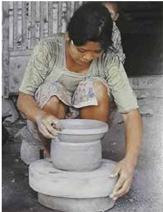
Proses pembuatan gerabah dengan menggunakan teknik roda putar Sumber : Cecep Eka Permana
