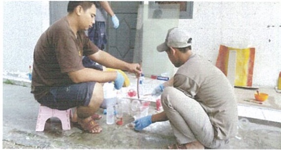
Proses pencampuran silicon rubber dan catalys silicon (Dok. BPCB Kalimantan Timur)
