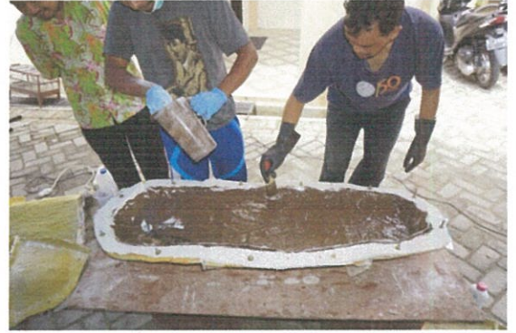
Proses pengolesan adonan resin, talk, dan catalys (Dok. BPCB Kalimantan Timur)
