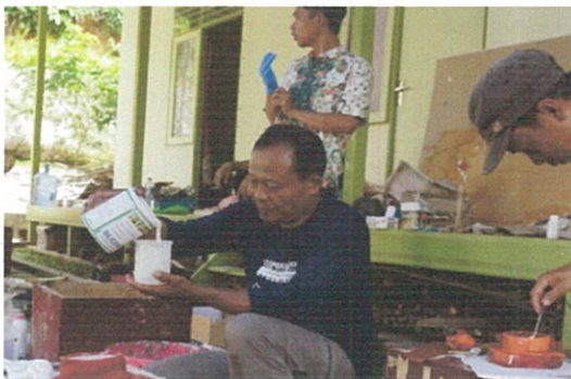
Prosen pencampuran silicon rubber dan catalys silicon (Dok. BPCB Kalimantan Timur)
