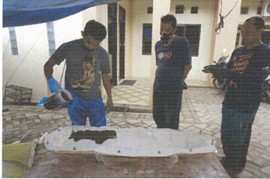
Proses pengolesan resin, pigmen warna, dan catalys pada cetakan negatif (Dok. BPCB Kalimantan Timur)
