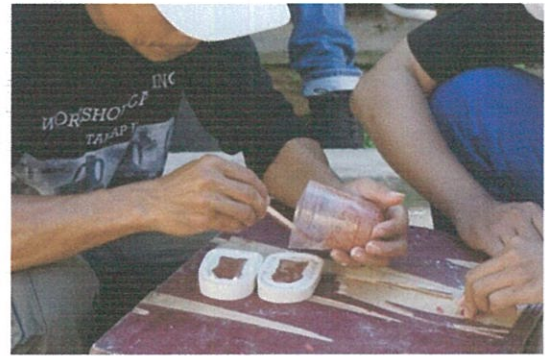
Proses penuangan silicon rubber dan catalys silicon (Dok. BPCB Kalimantan Timur)
