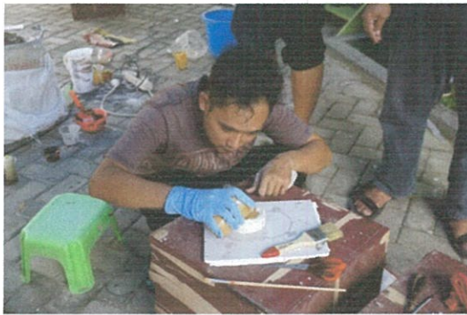
Proses penuangan silicon rubber dan catalys silicon (Dok. BPCB Kalimantan Timur)
