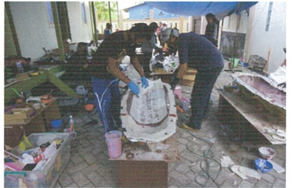
Proses memberikan mat/serat fiber pada cetakan negatif yang telah terlapisi adonan (Dok. BPCB Kalimantan Timur)
