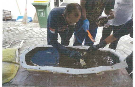
Proses pengolesan resin, pigmen warna, dan catalys pada cetakan negatif (Dok. BPCB Kalimantan Timur)
