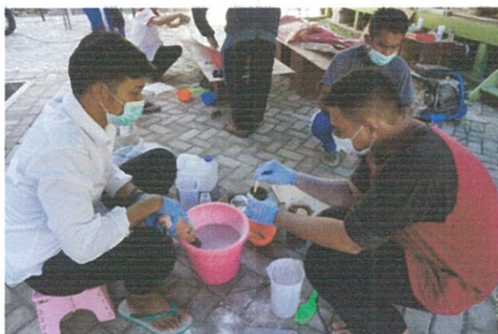
Proses pencampuran resin, pigmen warna, dan catalys (Dok. BPCB Kalimantan Timur)
