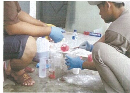
Proses pencampuran silicon rubber dan catalys silicon (Dok. BPCB Kalimantan Timur)
