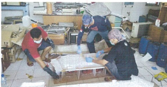
Mengoleskan silicon rubber pada seluruh permukaan yupa yang sudah diolesi silicon oil. (Dok. BPCB Kalimantan Timur)
