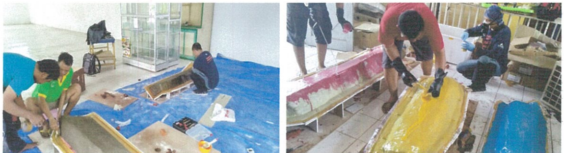
Foto 3.3 Proses pembuatan cetakan negatif Prasasti Yupa (Dok. BPCB Kalimantan Timur)
