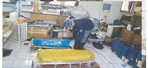
Mengoleskan resin pada seluruh permukaan yupa yang sudah diolesi silicon rubber (Dok. BPCB Kalimantan Timur)
