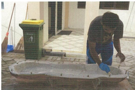
Proses pengolesan silicon oil (Dok. BPCB Kalimantan Timur)
