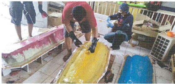
Mengoleskan resin pada seluruh permukaan yupa yang sudah diolesi silicon rubber (Dok. BPCB Kalimantan Timur)
