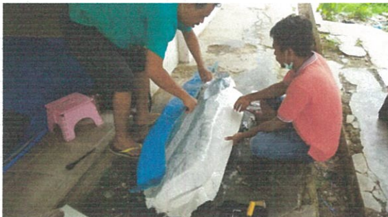
Membuka cetakan negatif duplikasi yupa yang telah kering (Dok. BPCB Kalimantan Timur)
