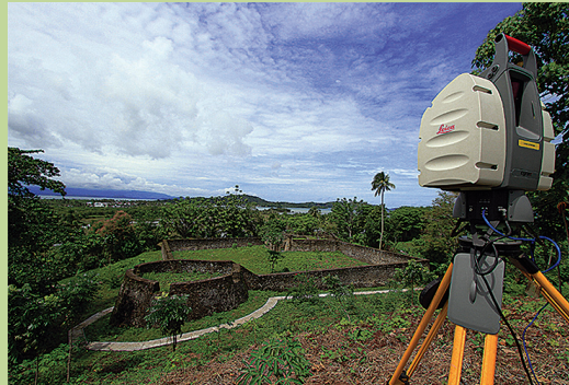
Pelaksanaan kegiatan pemetaan dengan menggunakan peralatan 3D Scanner di Struktur Cagar Budaya Benteng Orange, Desa Kwandang, Kabupaten Gorontalo Utara, Provinsi Gorontalo
