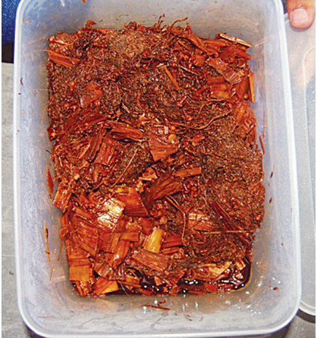
Foto 4.(kiri) : Bahan konservasi tradisional (Campuran tembakau, cengkeh, kulit batang pisang kering). Foto 5 (kanan) : Pengolesan bahan konservasi tradisional (Campuran tembakau, cengkeh, kulit batang pisang kering) pada bagian dinding Bangunan Cagar Budaya berbahan kayu. Diambil ketika kegiatan Diklat Konservasi Tingkat Menengah di Balai Pelestarian Konservasi Borobudur, Magelang.
