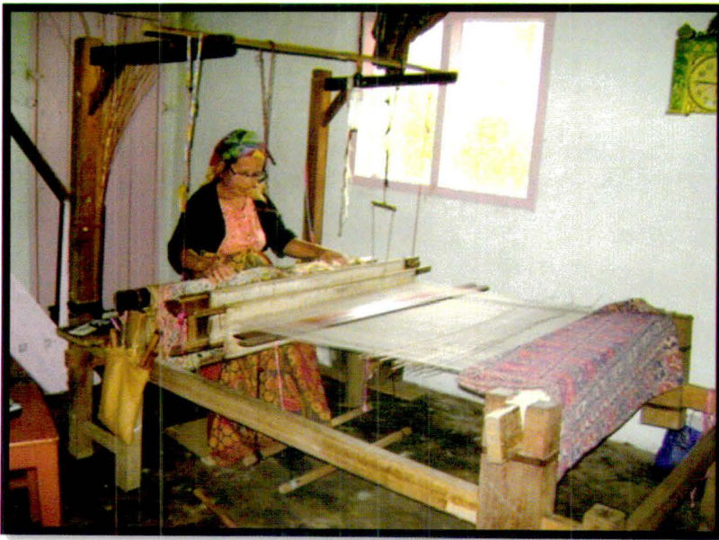
Foto 5. Panta adalah seperangkat alat tenun tradisional untuk menenun songket di Nagari Pandai Sikek
