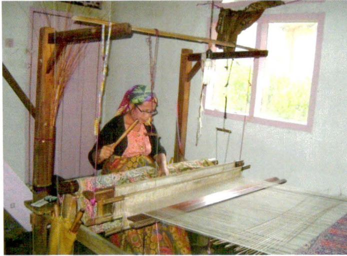
Foto 13. Paso, alat untuk menggulung tenunan yang sudah jadi
