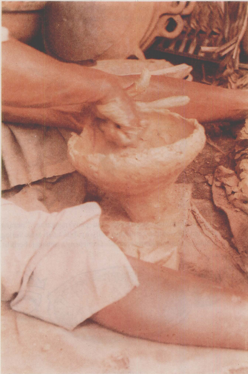
FOTO : 2. PROSES PEMBUATAN GERABAH PADA TAHAP "BADANGAN"
