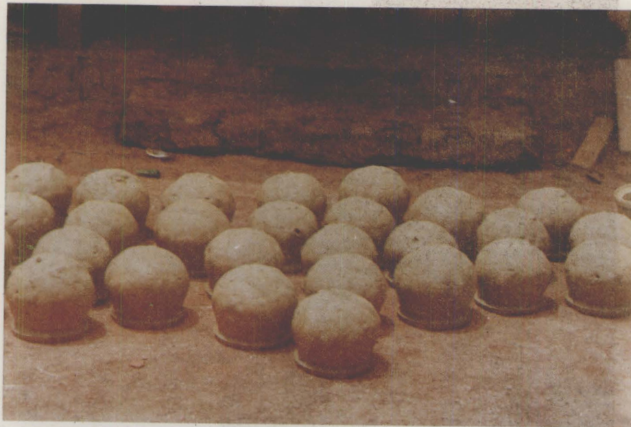
FOTO : 5. HASIL DARI TAHAP JELLUWAN YANG DIJEMUR UNTUK KEMUDIAN DILANJUTKAN DENGAN PROSES PERATAAN MEMAKAI ALAT PANEMPA DAN PANOMBUK.
