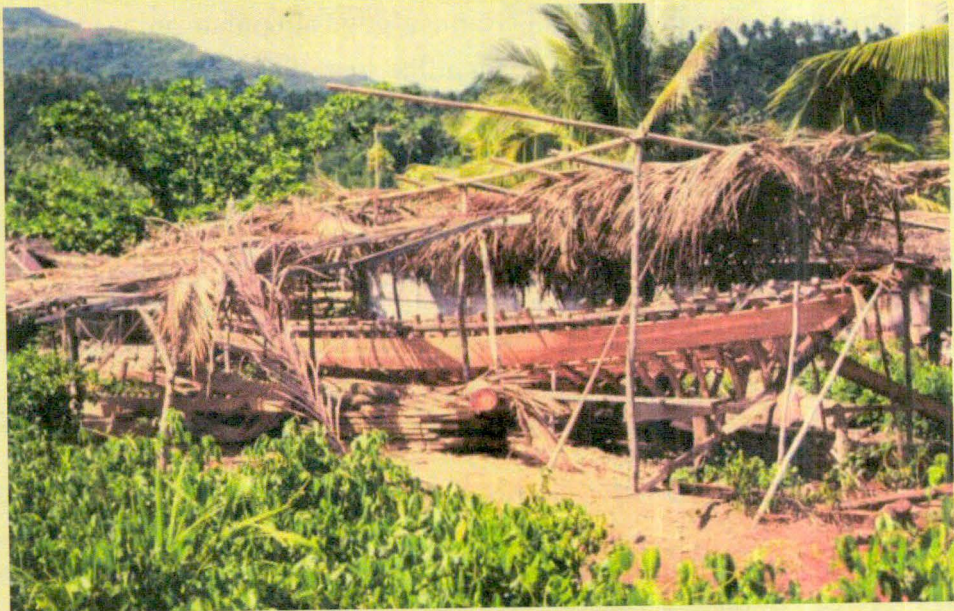
Gambar 4. Dua rangka perahu dengan ukuran panjang lunas 10 meter. Dikerjakan sendiri oleh seorang tukang, di Manganitu, pulau Sangihe (koleksi penulis)
