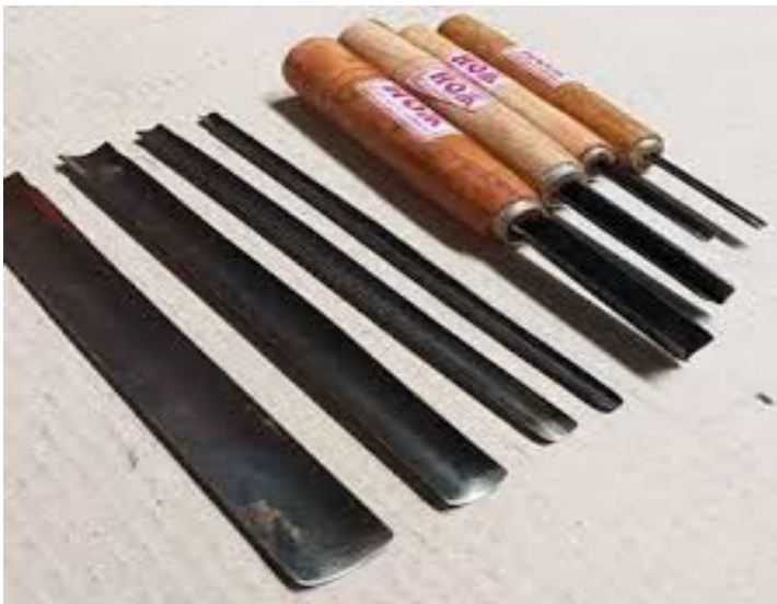
Gambar 4.2.1.1 Alat pahat untuk membuat lubang atau Song Soling
