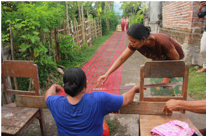
Salah satu proses penyiapan benang yang disebut Nyasah
