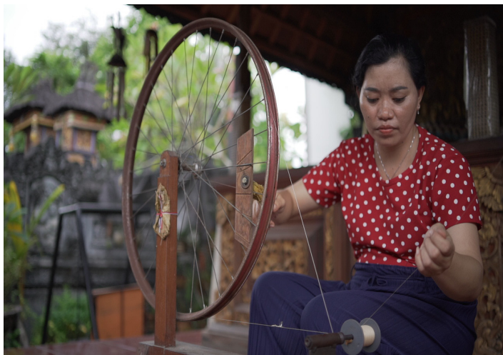
Proses Penyiapan benang disebut dengan Ngeliyung
