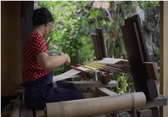
Proses Menenun Kain Tenun Cagcag
