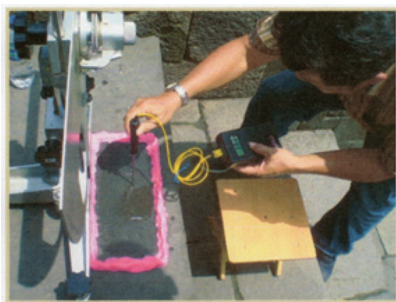
Gambar 2. Pengukuran nilai uji kekesatan permukaan dengan alat British Pendulum Tester (BPT)
