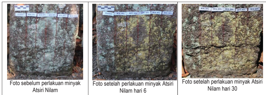
Gambar pengujian minyak atsiri nilam untuk membersihkan lumut kerak (Sumber: Wahyuni, dkk, 2015)
