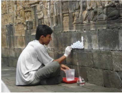
Gambar percobaan penempelan bubur kertas pada permukaan batu yang terdapat endapan garam (Sumber: Swastikawati, dkk, 2010)
