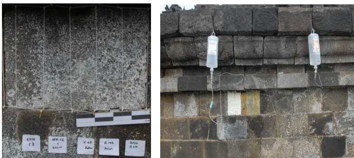
Percobaan menggunakan larutan EDTA 5% dan resin penukar ion (Sumber: Wahyuni S, dkk, 2014)
