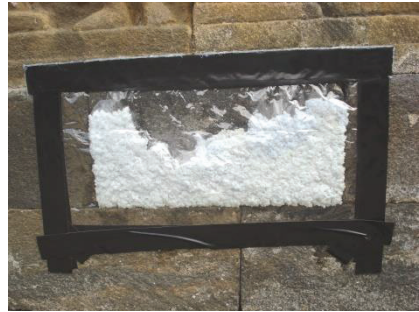
Gambar percobaan penempelan bubur kertas pada permukaan batu yang terdapat endapan garam (Sumber: Swastikawati, dkk, 2010)
