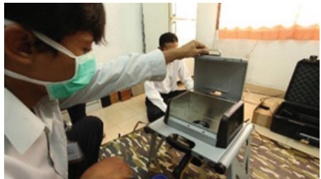
Analisis unsur menggunakan metode X-Ray Fluorescence (dok : BK Borobudur, 2014)
