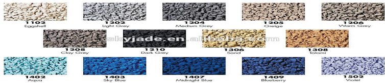
Gambar 5. Jenis karet EPDM granule yang digunakan sebagai bahan uji coba pelapisan tangga
