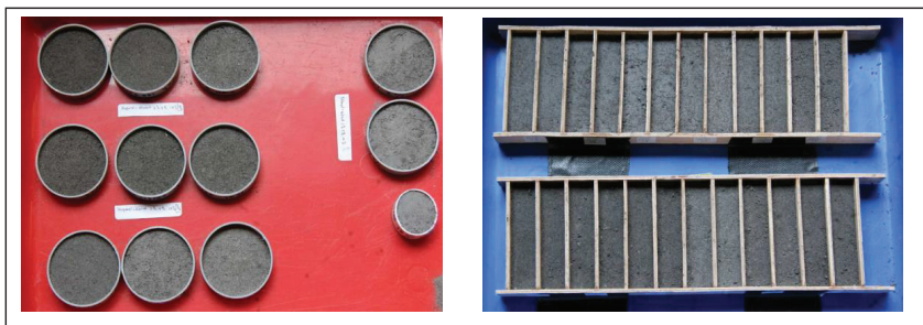
Gambar mortar etil silikat yang dicetak (Sumber: Muhammad R, dkk, 2016)
