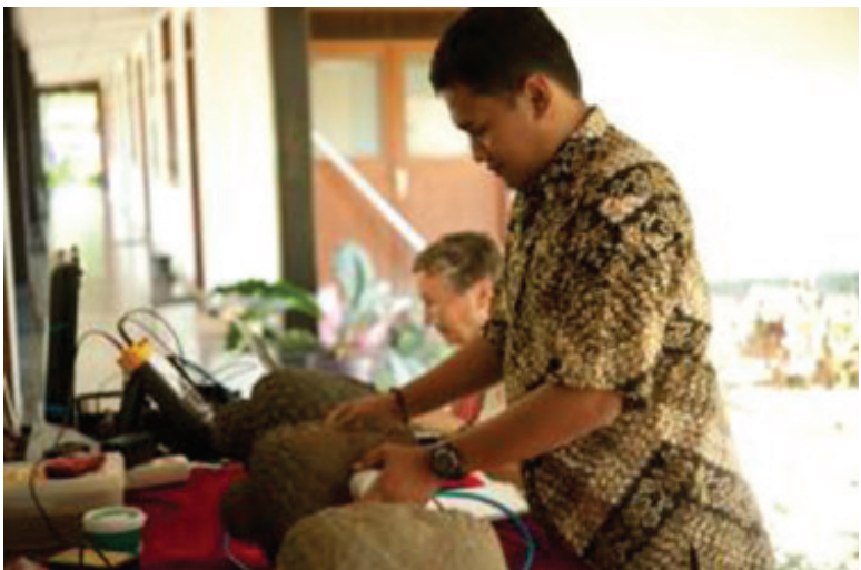
Pengukuran menggunakan ultrasonic pulse velocity tester (Sumber: Setyawan, dkk, 2015)
