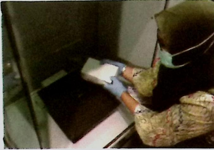
Gambar 9.7 Peletakan Gel Silika dalam Wadah Kotak Berpori ke dalam Vitrin (Museum Nasional, 2020)
