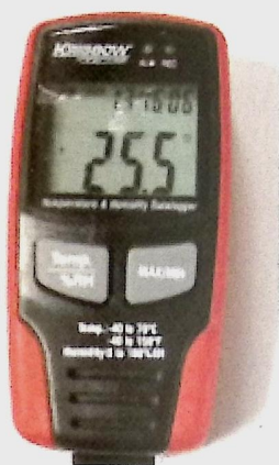
Gambar 8.12 Data Logger; Tampilan Layar Data Logger Menunjukkan Temperatur ( ^{\circ}\text{C} ) yang Terdeteksi
