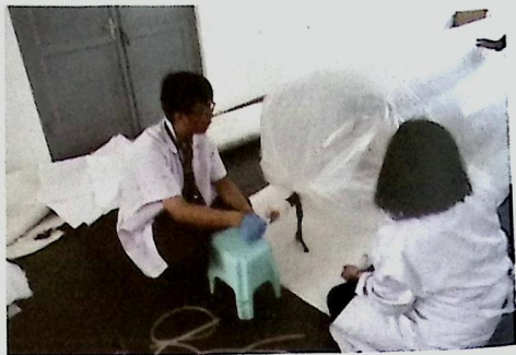
Gambar 5.21 Uji Coba Kebocoran Chamber/Container Fumigasi Menggunakan Udara dari Pompa Listrik
