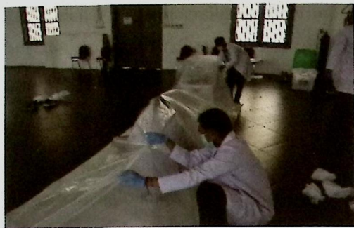
Gambar 5.21 Uji Coba Kebocoran Chamber/Container Fumigasi Menggunakan Udara dari Pompa Listrik
