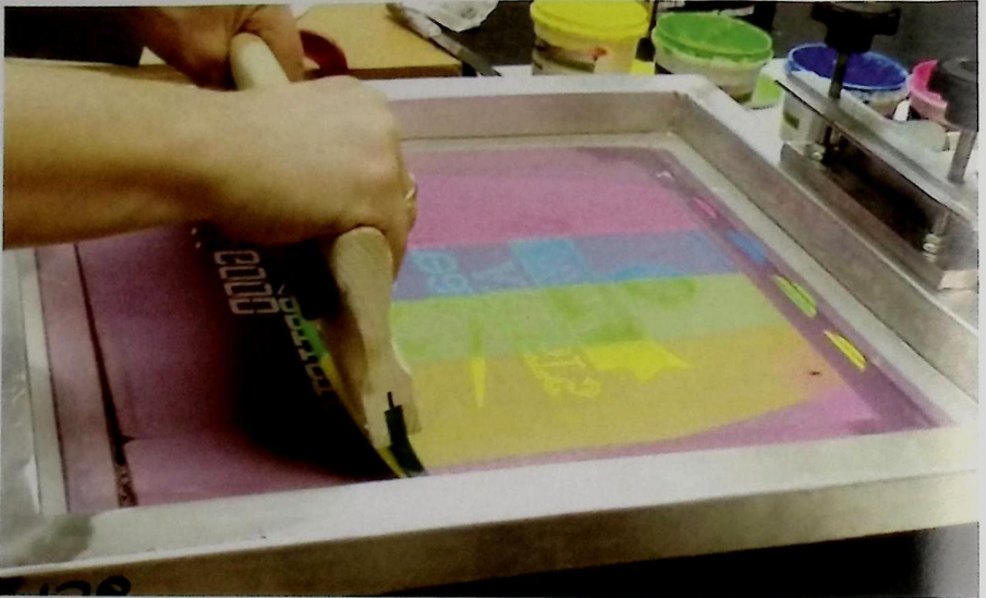
Gambar 3.15 Teknik Sablon dengan Alat Screen dan Roller/Rakel
