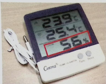
Gambar 8.13 Termohigrometer; Bagian yang Ditandai Menunjukkan Nilai Kelembapan Relatif (RH) (Museum Nasional, 2020)
