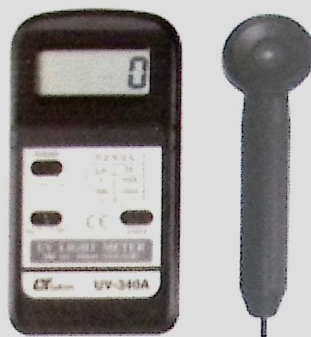
Gambar 8.8 UV Meter Merek Lutron dengan Reseptor Cahaya dan Dua Cakupan Rentang Nilai Cahaya Ultraviolet (Tinggi-Rendah)
