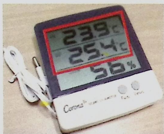
Gambar 8.11 Termohigrometer; Bagian yang Ditandai Menunjukkan Nilai Temperatur Inside (Atas) dan Temperatur Outside (Bawah)
