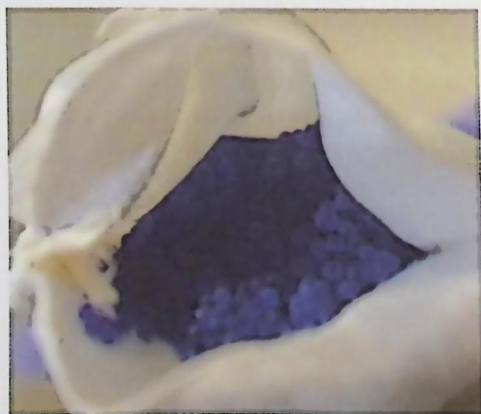
Gambar 5.15 – Desikan Gel Silika Biru (Kiri) akan Berubah Warna Menjadi Merah Muda (Kanan) setelah Jenuh
