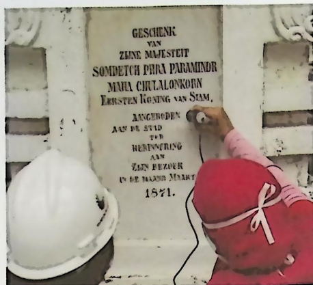
Gambar 4.21 – Identifikasi Permukaan Prasasti Menggunakan Mikroskop Digital.
