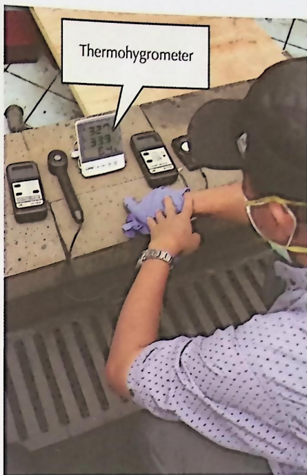
Gambar 4.50 – Kegiatan Pengukuran Nilai Kelembapan Relatif (RH) dan Temperatur Menggunakan Termohigrometer
