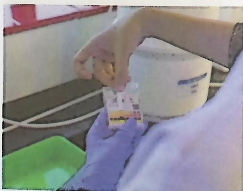
Gambar 6.70 – Pengecekan pH dengan Indikator Universal
