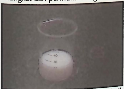
Gambar 6.66 – Terbentuk Endapan Putih \text{AgCl}
