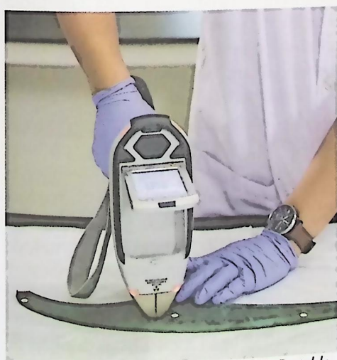
Gambar 6.92 – Identifikasi dengan XRF Portable
