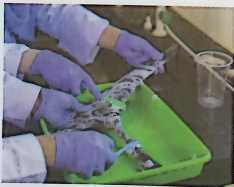
Gambar 6.68 – Pencucian untuk Menghilangkan sisa Larutan Natrium Seskuikarbonat
