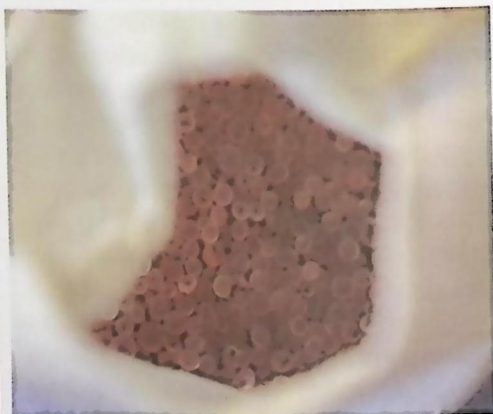
Gambar 5.15 – Desikan Gel Silika Biru (Kiri) akan Berubah Warna Menjadi Merah Muda (Kanan) setelah Jenuh
