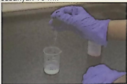
Gambar 6.65 – Penetesan Larutan \text{AgNO}_3 pada Sampel Uji
