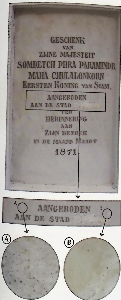
Gambar 4.23 – Prasasti Berbahasa Belanda yang Mengalami Pengikisan pada Tulisan "Batavia". A. Gambar Mikro Bagian Tidak Terkikis. B. Gambar Mikro Bagian Terkikis.
