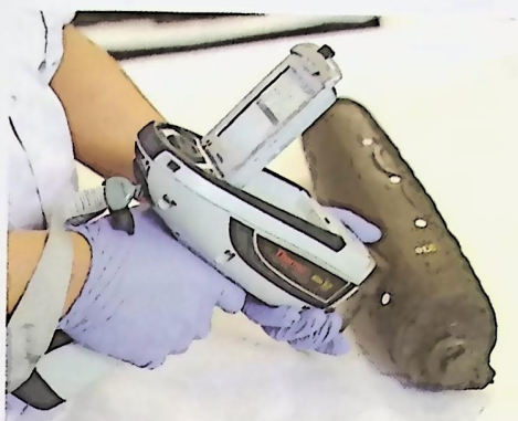
Gambar 5.7 – Analisis Komposisi Unsur Prasasti Sadapaingan Menggunakan Spektrofotometer XRF
