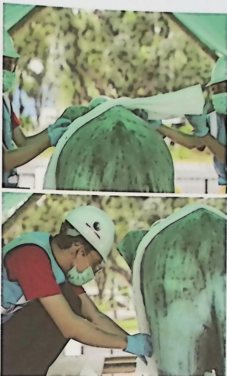
Gambar 4.55 – Proses Uji Coba dengan Larutan Seskuikarbonat
