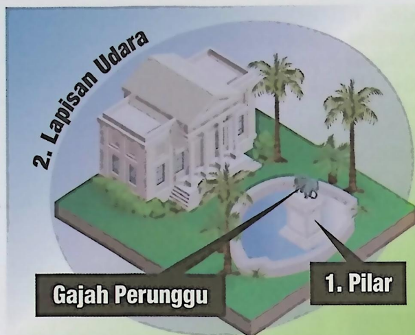
Gambar 4.33 – Lapisan Pelindung Patung Gajah Perunggu di Ruang Pamer Terbuka Mengadaptasi dari A Guide to Risk Management of Cultural Heritage , (ICCROM, 2016)
