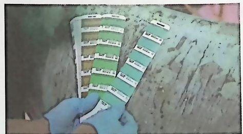
Gambar 4.6 – Identifikasi Warna Korosi pada Permukaan Koleksi dengan Kartu Pantone .
