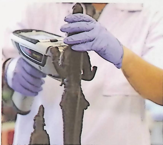
Gambar 5.12 – Analisis Komposisi Unsur Arca Lokanatha Menggunakan Spektrofotometer XRF
