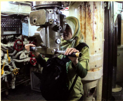
Periskop Untuk Melihat Sekeliling Kapal Selam Periscope for Observation Around the Submarine
